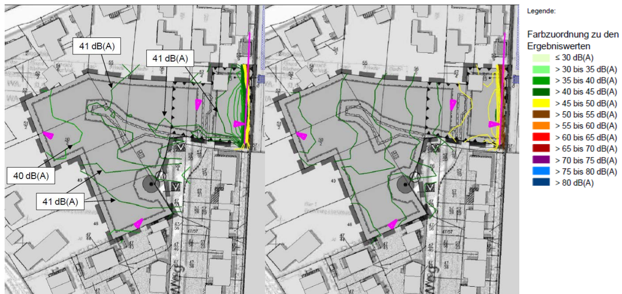
Abb. 2: Rasterlärmmappe Gewerbe nachts mit LSW Var. 3 (h=6 m, l=60 m), Berechnungshöhen 2 m / 5 m
