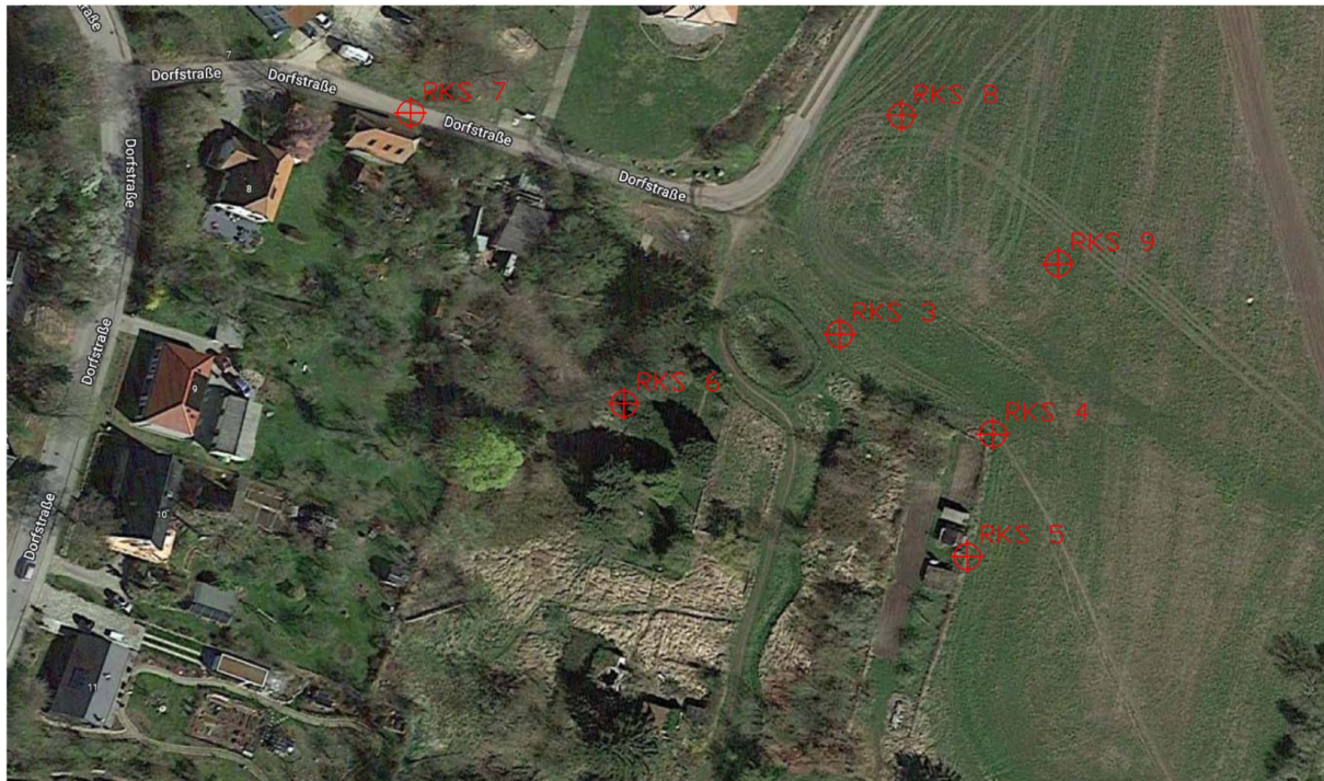
Abb. 9: Lage der Rammkernsondierungen von Heiden Labor GmbH (2023/2024)
